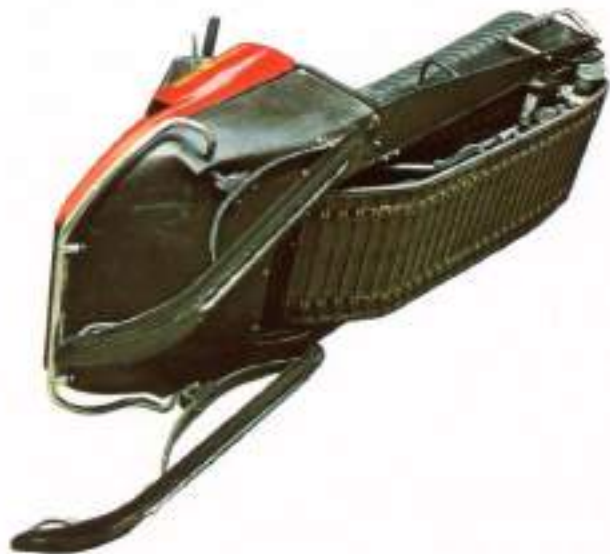
Cingolo completamente in gomma a disegno speciale. Larghezza cingolo cm. 46.
