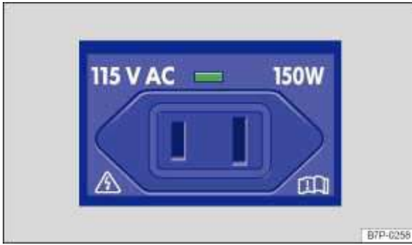
Fig. 124 Rear center console: 115 Volt socket.
