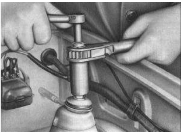
Bild F 38. Stoßdämpferbefestigung lösen
