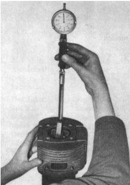
Bild M 36. Zylinderbohrung messen
