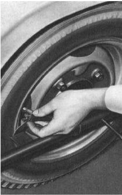
Bild F 27. Hinterräder- Vorspur überprüfen
