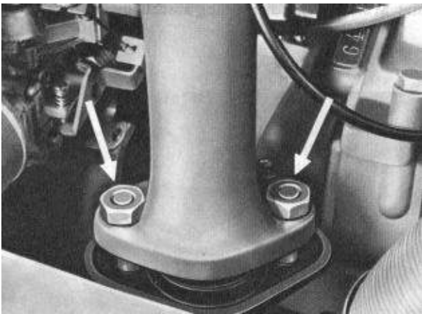
Bild M 8. Vorschalldämpfer abschrauben
