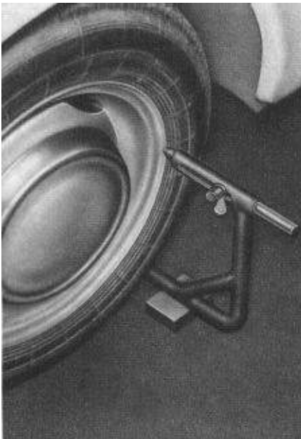
Bild F 21. Vorspur überprüfen
