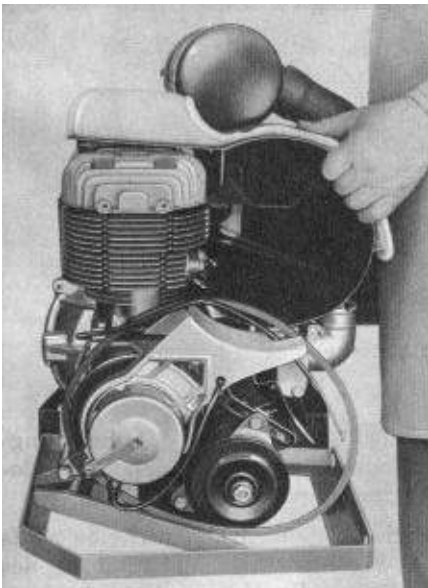
Bild M 13. Kühlluftgehäuse abnehmen
