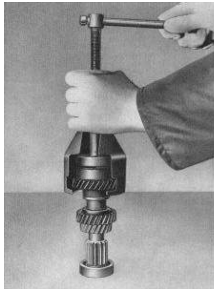
Bild G 12. Rillenkugellager und 4. Gangrad abziehen
