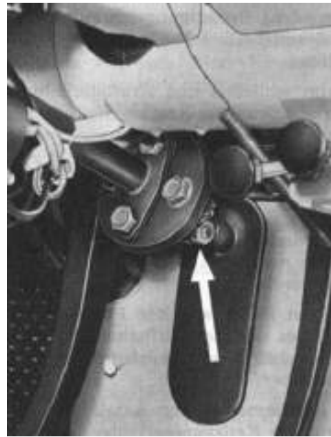
Bild M 46. Lenksäulenkupplung lösen
