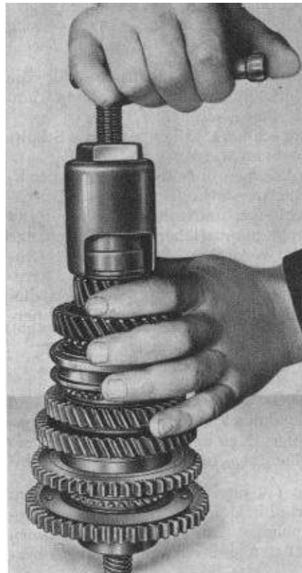
Bild G 16. Innenring vom Zylinderrollenlager abziehen
