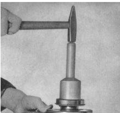
Bild M 28. Kugellager aufschlagen
