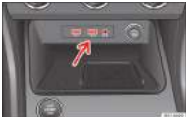
Fig. 121 Centre console: USB/AUX-IN input.
