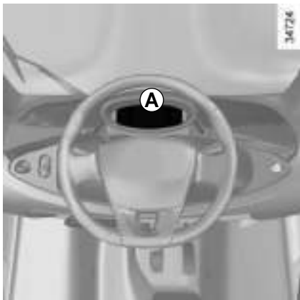
Instrumententafel A: wird beim Einschalten der Zündung beleuchtet.
