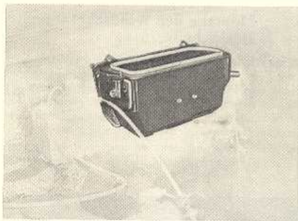
Bild K 42. Wärmetauscher der Heizung
