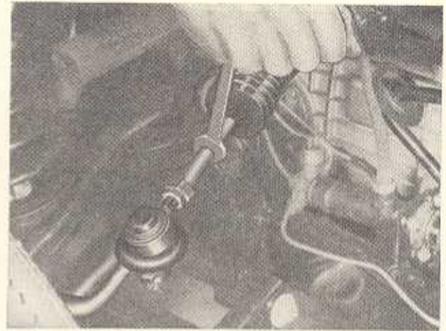
Bild F 30. Einstellen der Spurstangen
