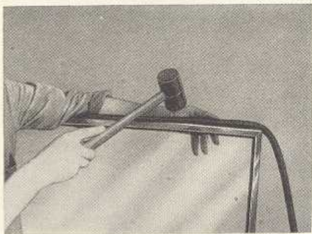
Bild K 20. Einziehen des Abdichtgummis in den Rahmen mit Gummihammer
