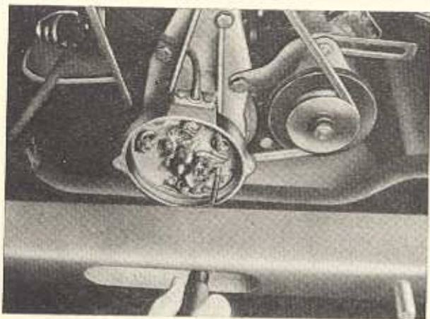
Bild M 49. Zur Wartung am Fahrzeug vorbereiteter Anbau-Dreihelunterbrecher beim Baumuster 353
