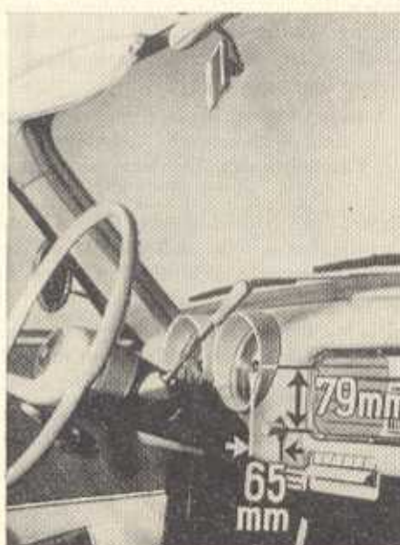
Bild E 19. Einbau der Pumpe für die Scheibenwaschanlage
