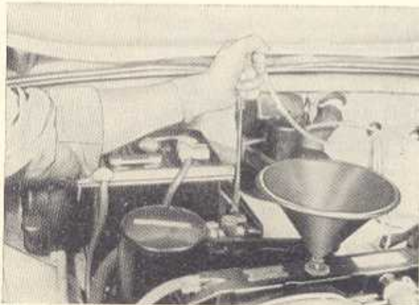
Bild M 78. Entlüften des Wärmetauschers
