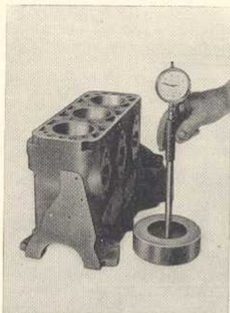
Bild M 12. Einstellen der Meßuhr mit Lehring
