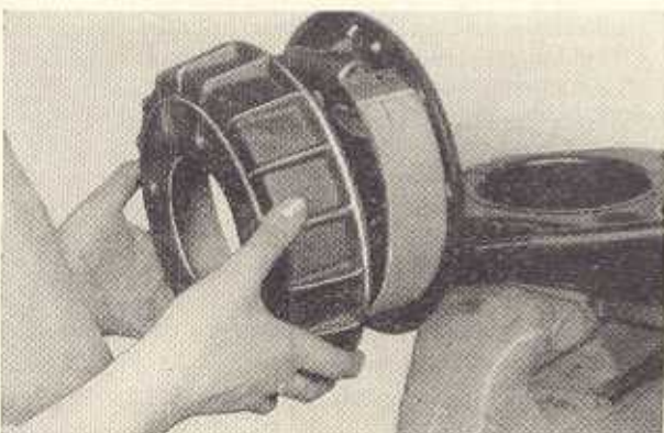
Bild F 80. Aufstecken der Bremstrommel
