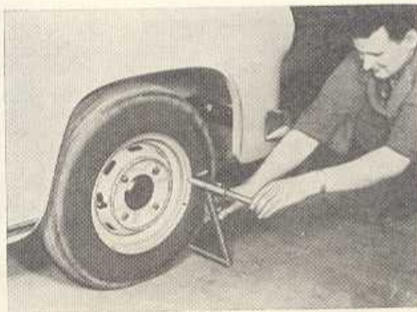
Bild F 61. Einstellen der Vorspur
