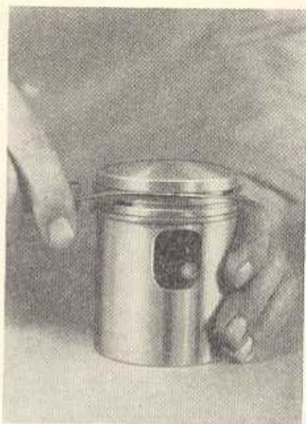
Bild M 19. Messen des Höhenspiels der Kolbenringe
