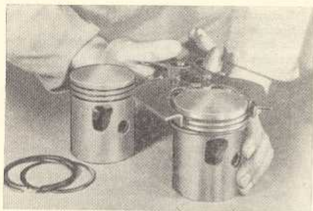
Bild M 17 Abnehmen und Aufziehen der Kolbenringe mit Kolbenringzange
