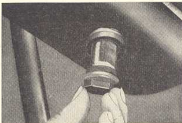
Bild M 54. Herausnehmen des Siebes für das Steigrohr
