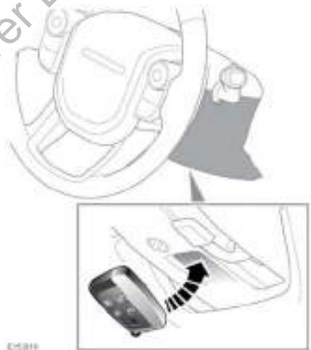
1. Posizionare la chiave Smart contro il lato inferiore del piantone dello sterzo con i tasti rivolti verso il basso.
