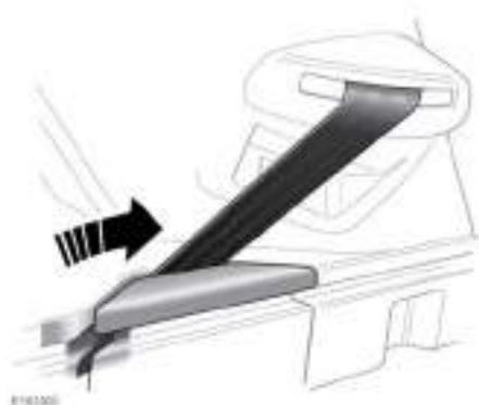
Per poter srotolare e ritrarre la copertura del vano di carico senza urtare la cintura di sicurezza, far passare la cintura di sicurezza nel fermaglio sul rivestimento, posizionato nella parte posteriore del vano di carico. Per maggiori informazioni sulle cinture di sicurezza dei sedili della terza fila, vedere **32, USO DELLE CINTURE DI SICUREZZA**.
