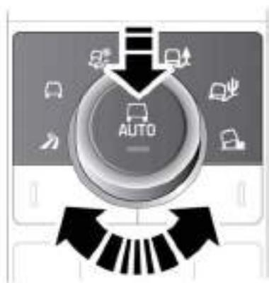
La selezione del Terrain Response viene effettuata mediante una manopola. Attorno alla manopola sono indicati 6 programmi Terrain Response.
