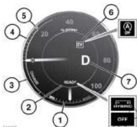
1. Livello di carica della batteria ibrida: durante il normale funzionamento, la lancetta si sposta tra **MIN** e il segno spesso bianco prima di accedere all'area blu. La lancetta può entrare nell'area blu quando si ricarica in modalità EV o per il recupero di energia durante la decelerazione del veicolo.
