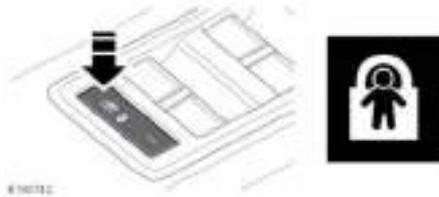
Se si devono trasportare bambini sul sedile posteriore, si raccomanda di disattivare le maniglie interne delle portiere posteriori.
