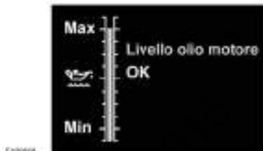
Se il livello dell'olio è compreso nel normale intervallo di funzionamento, viene visualizzato il messaggio **Livello olio motore OK**. Non aggiungere altro olio al motore.
