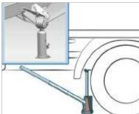
Приемная точка для автомобильного домкрата, задний мост (пример: грузовой а/м с бортовой платформой до 3,5 т)
