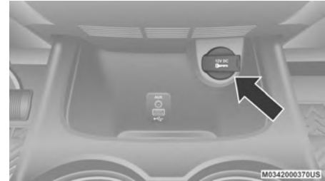
Front 12 Volt Power Outlet
