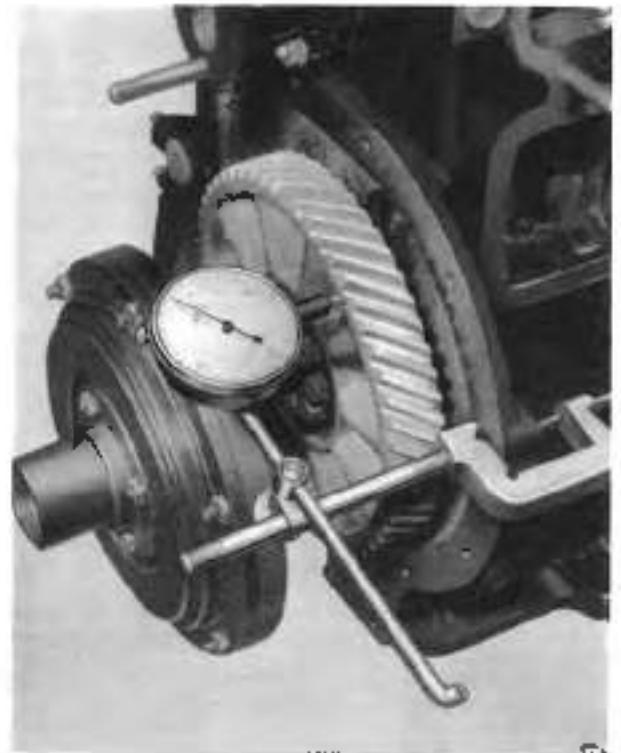
Fig. E10 Checking camshaft end float
