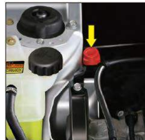
Устройство отсечки подачи топлива
