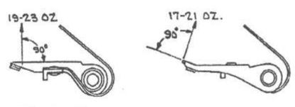
Fig. 12.— MEASUREMENT OF CONTACT-POINT PRES-SURE
