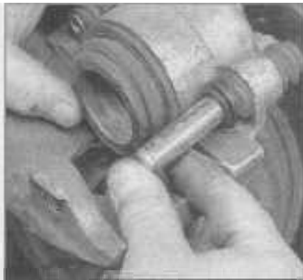
3.4e Remove the guide pin bushings
