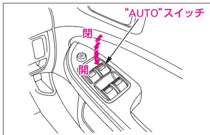
自動開閉中にウィンドーを停止させるときは、スイッチを作動方向とは逆へ軽く操作します。
