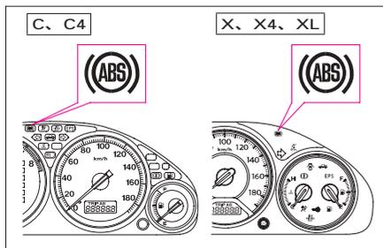
エンジンスイッチを“II”にしたとき点灯し、数秒後に消灯するのが正常です。また、運転中に数秒間点灯してもすぐ消灯し、その後走行中に点灯しなければ正常です。
