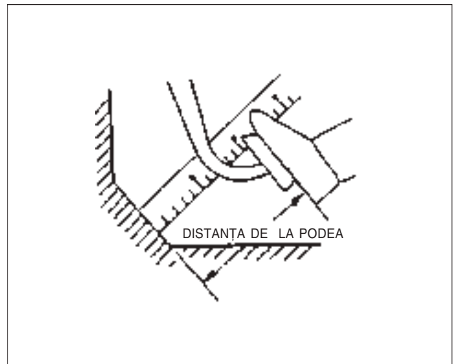
FIG. 8B – 5 DISTANȚA ÎNTRE PEDALĂ ȘI PODEA ÎN MOMENTUL DINAINTEA CUPLĂRII AMBREIAJULUI
