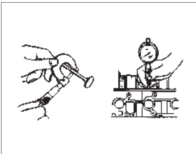
FIG. 6B – 54 MĂSURAREA DIAMETRULUI COZII DE SUPAPĂ ȘI DIAMETRULUI INTE- RIOR AL GHIDULUI
