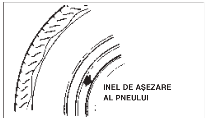
Fig. 5 Inelul de așezare al pneului
