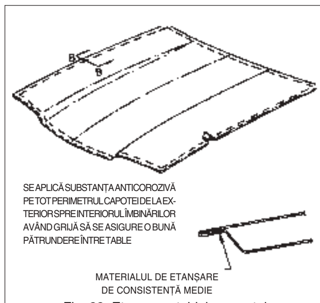
Fig. 22 Etanșarea tablelor capotei
