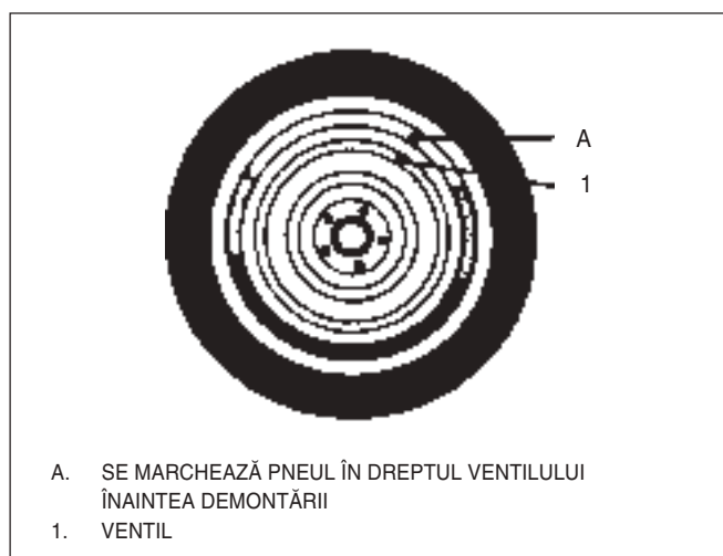
Fig. 7 Montarea împerecheată a jenții și pneului
