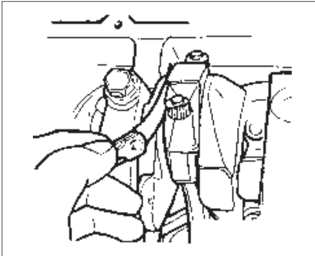
Fig. 18 Măsurarea jocului lateral al bielor
