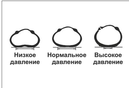
Состояние шин следует проверять до запуска двигателя, а давление воздуха в шинах - при каждой заправке топливного бака или, по крайней мере, один раз в месяц (с использованием манометра).
