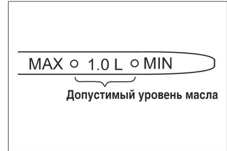
8. Если уровень ниже отметки **MIN**, добавьте необходимое количество масла той же марки и вязкости, что и в двигателе, чтобы поднять уровень масла до максимального. Превышение отметки **MAX** недопустимо. Крышка маслозаливной горловины двигателя расположена на крышке головки цилиндра (см. рис. ниже). Для получения информации о характеристиках моторного масла см. „КАРТА СМАЗКИ”.
