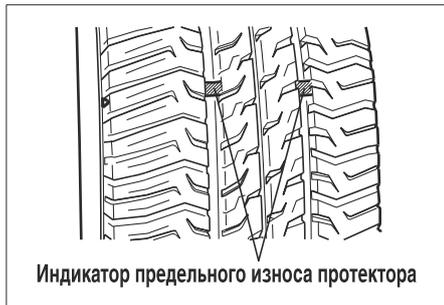
При появлении индикаторов предельного износа протектора замените шины. Индикаторы появляются между углублениями протекторов, если глубина протектора составляет **1,6 мм** или меньше.
