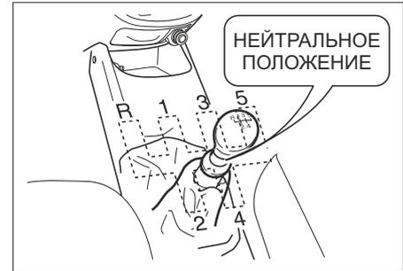
5. Не нажимая на педаль акселератора, поверните ключ зажигания в положение **START** и после запуска двигателя отпустите ключ. Если двигатель запускается, но снова глохнет, то перед следующей попыткой запуска выждите **10** секунд.
