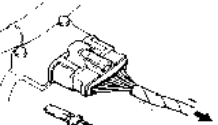
Обрыв провода в месте вывода
