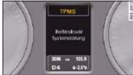
Fig. 28 Display: System fault ("Systemstörung")
