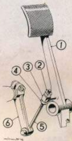
Fig. 28. Regolazione del gioco del pedale della frizione. 1. Pedale comando disinnesto frizione - 2. Dadi fissaggio perno-puntone comando frizione - 3. Perno regolazione-puntone - 4. Puntone comando frizione - 5. Puntone comando frizione - 6. Leva di rinvio comando frizione.
